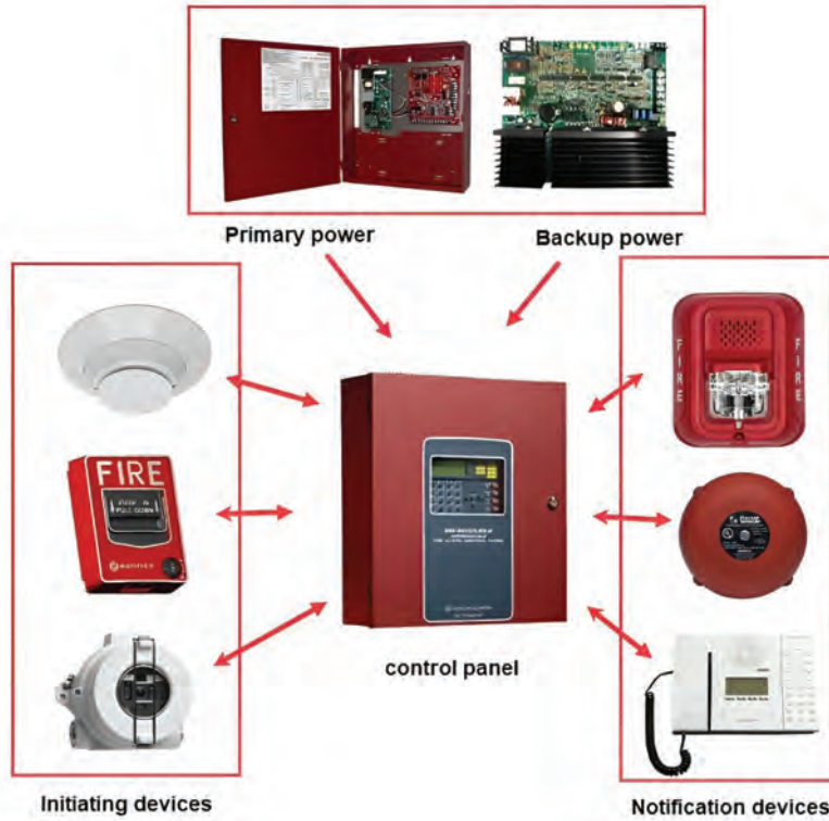
الأجزاء الأساسية لنظام إنذار الحريق
