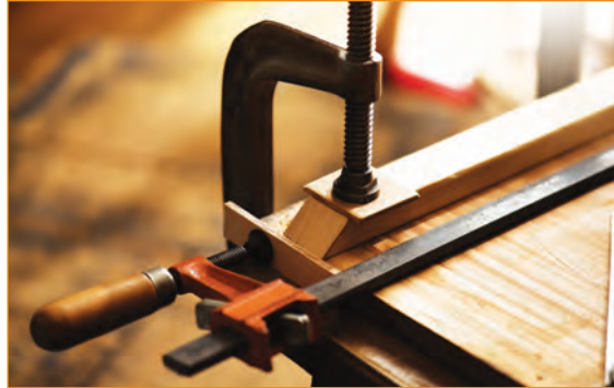
استخدام المشبك في أعمال النجارة
