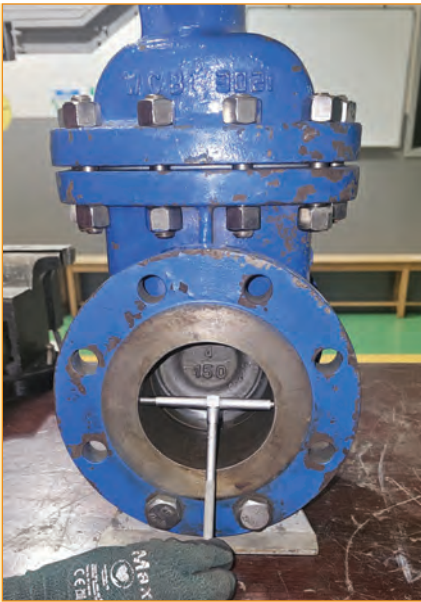
استخدام ناقل المقاييس التلسكوبي
