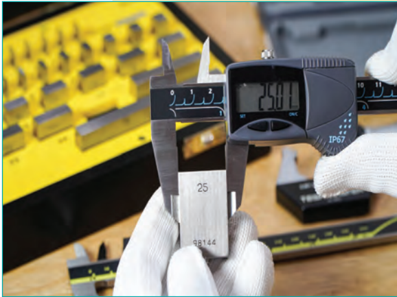
فحص الدقة باستخدام المعكات المعيارية
