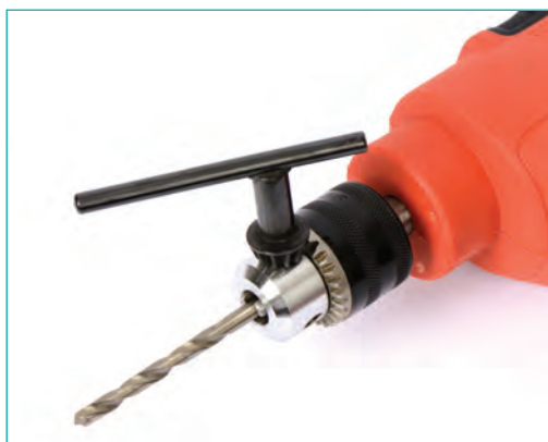
مفتاح الظرف في المثقاب الكهربائي
