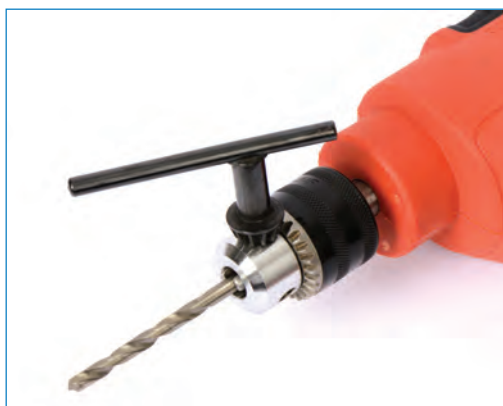
مفتاح الظرف في المثقاب الكهربائي
