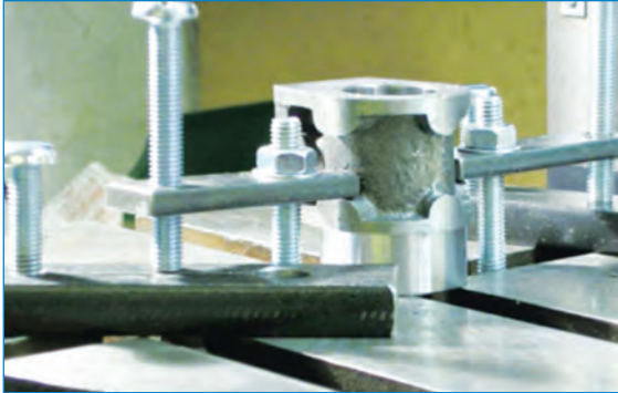
استخدام المشبك في القوالب المعدنية
