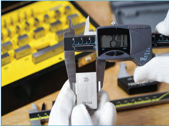
فحص الدقة باستخدام المعكات المعيارية
