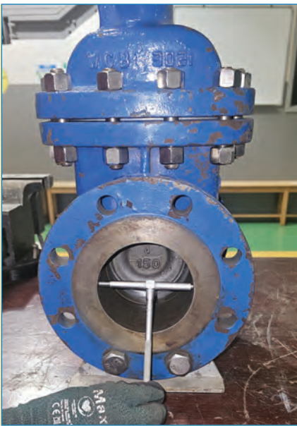
استخدام ناقل المقاييس التلسكوبي
