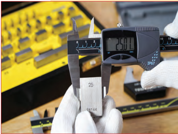
فحص الدقة باستخدام المكعبات المعيارية
