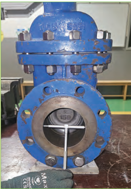
استخدام ناقل المقاييس التلسكوبي
